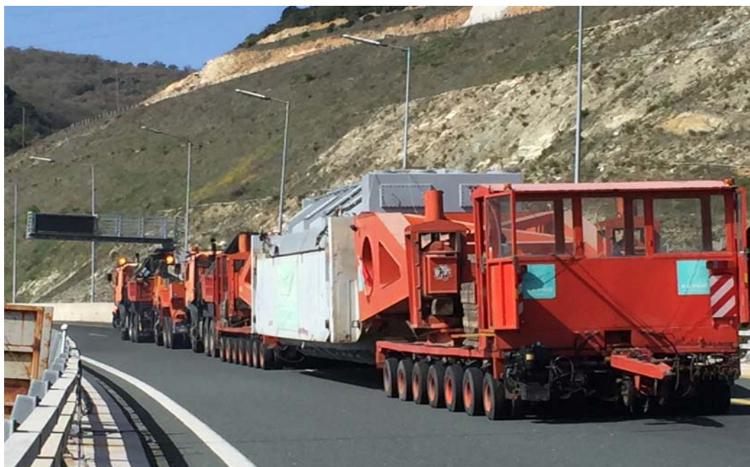
Σχήμα 4. Ειδική μεταφορά μετασχηματιστή ΔΕΗ
