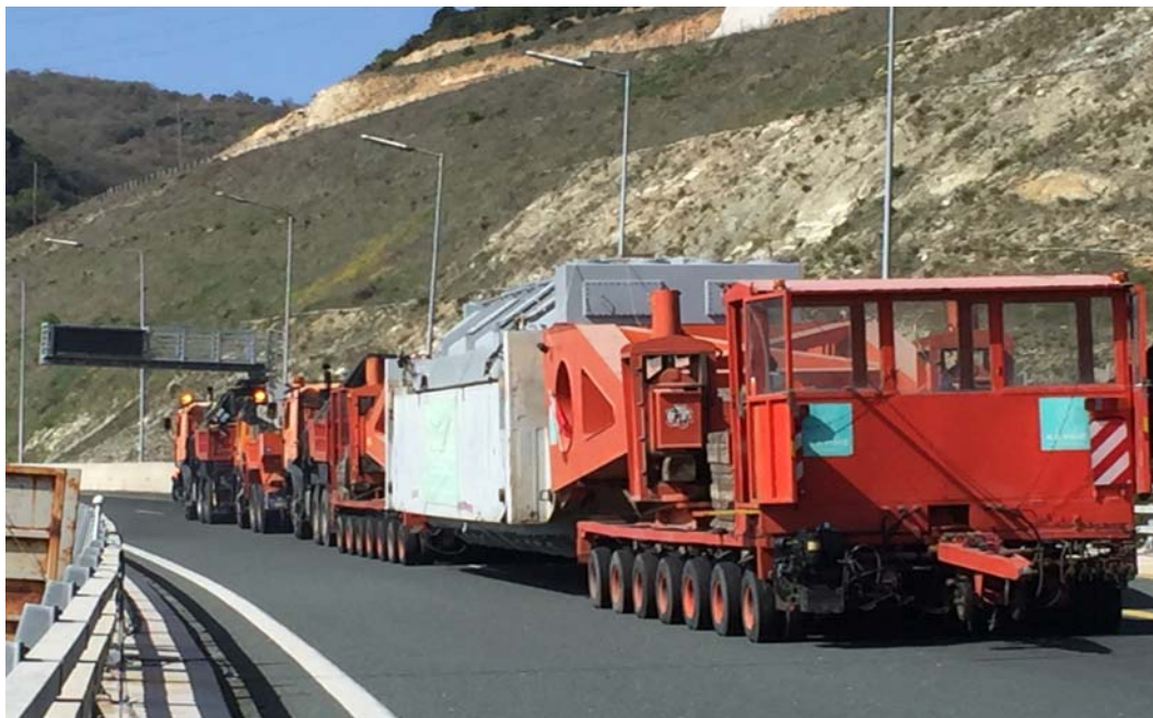
Εικόνα 1. Μεταφορά μετασχηματιστή ΔΕΗ
